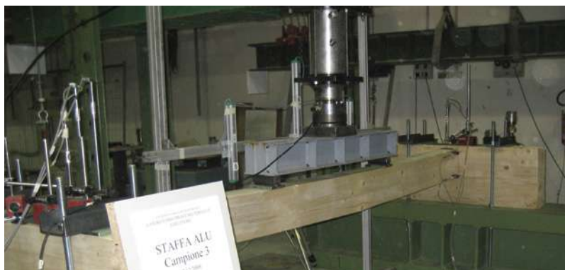
Prove su campioni di dimensioni reali (connessione trave principale-secondaria).
