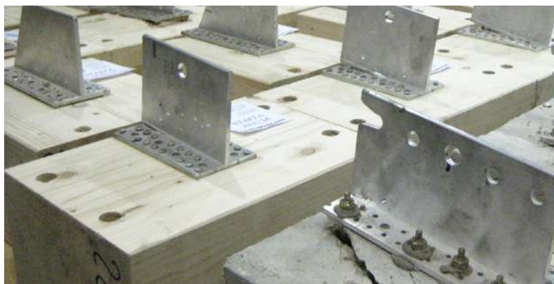
Prove su campioni di dimensioni ridotte (legno-legno e legno-calcestruzzo).
